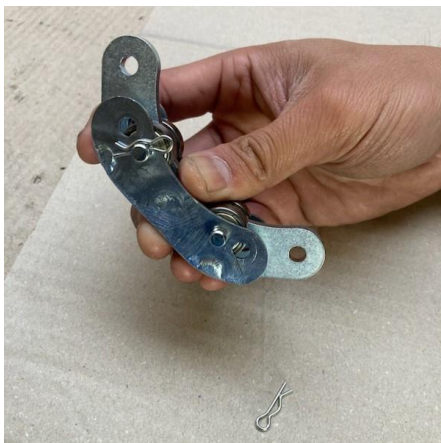
1、ピンを外します。 (ピンをなくさないようにしてください。)
